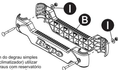
OBS: Para montagem do degrau simples (sem reservatório de climatizador) utilizar parafusos «E» e degraus com reservatório de climatizador utilizar parafusos «D».
